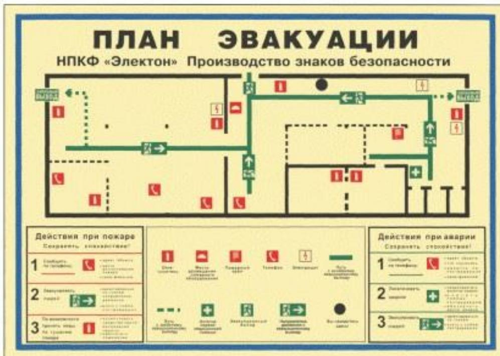
Рис.3 Пример плана эвакуации со всеми необходимыми условными обозначениями
